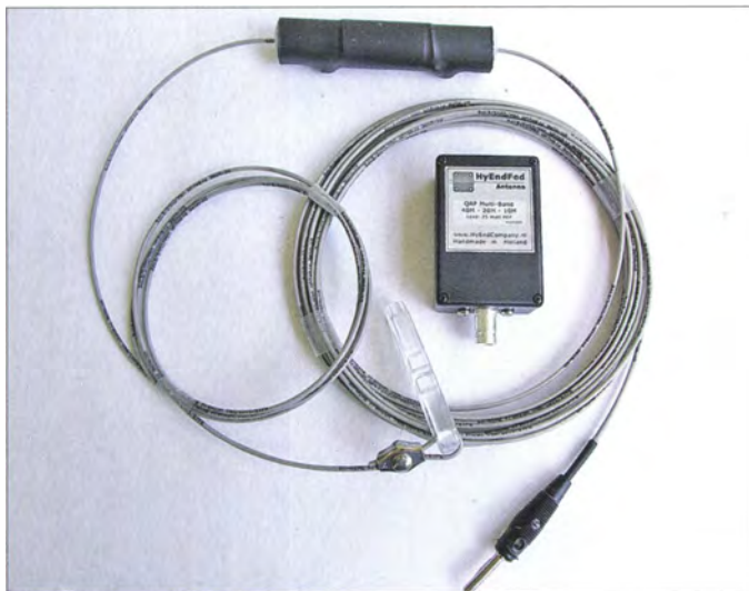
Bild 1: Lieferumfang der Portabelantenne für QRP-Betrieb auf 40 m, 20 m und 10 m; Spule und Unun sind wettergeschützt verbaut.
