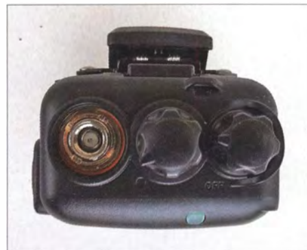
Die Drehknöpfe sind griffig gestaltet; links daneben die Reverse-SMA-Antennenbuchse.
