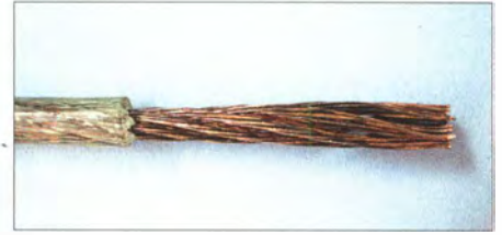
Bild 11: Kupferlitze Typ 3 von Kabel-Kusch, 3,4 mm
