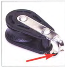
Bild 5: Der Versuch, eine Seilrolle mit einem Loch zum Anschrauben zu versehen, endete erfolglos ...
