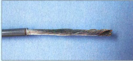
Bild 7: DX-Wire Premium, Kupferdrahtauflage auf Stahlkern
