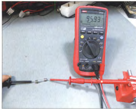
Bild 1: Kaum zu glauben, aber wahr: Die 30-A-Sicherung weist fast 96 Ω Durchgangswiderstand auf.
