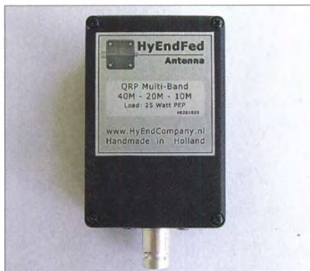
Bild 2: 1:49-Übertrager (Unun) mit Anschlussbuchsen für Strahler und Koaxialkabel
