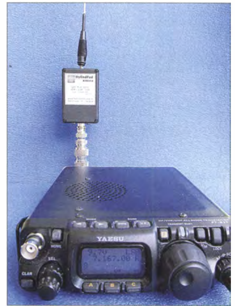
Bild 3: Anschluss der Antenne direkt am Funkgerät
