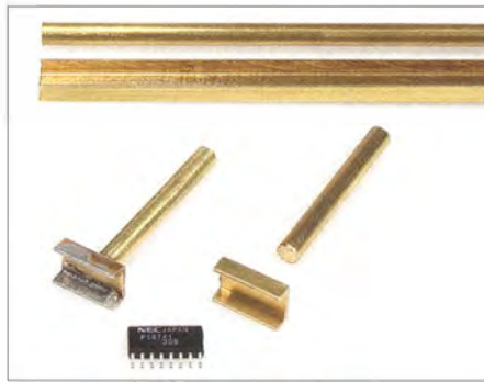
Bild 37: Das 6 mm breite U-Profil aus Messing ist auch gut zum Auslöten von SMD-Schaltkreisen im SSOP-Gehäuse geeignet.
