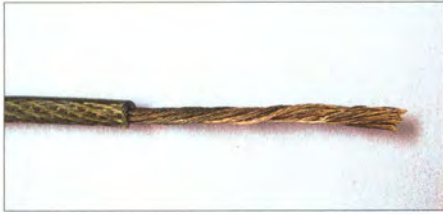
Bild 9: Kupferlitze Typ 1 von Kabel-Kusch, 2,1 mm
