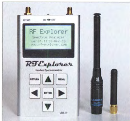
Bild 1: Im Lieferumfang des RF-Explorers sind zwei Antennen mit SMA-Steckern enthalten.
