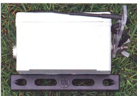
Bild 1: Balungehäuse mit einem Plastik- Antennenisolator zur Befestigung
