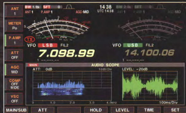
Audioskop-Anzeige mit Wasserfall-Darstellung
