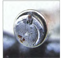
Bild 2: Die schlechte Lötstelle als vermutliche Fehlerursache
