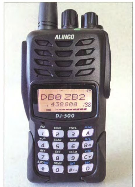
Das DJ-500E zeigt hier im Hauptband einen Speicherplatznamen und im Subband eine Frequenz an.
