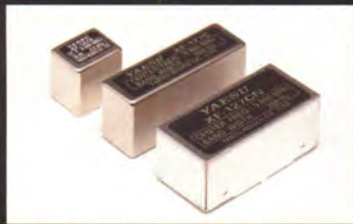
300 Hz, 600 Hz, 3 kHz Roofing-Quarzfilter
