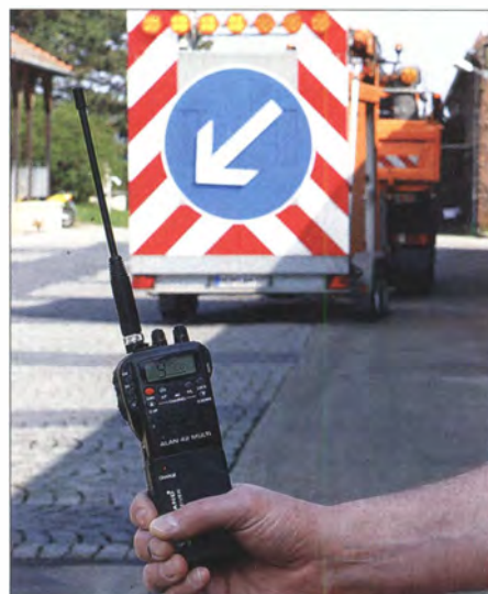
Bild 4: Zum CB-GSW gehört ein solches Handfunkgerät, um damit die Aussendung der Warnansagen zu prüfen.
