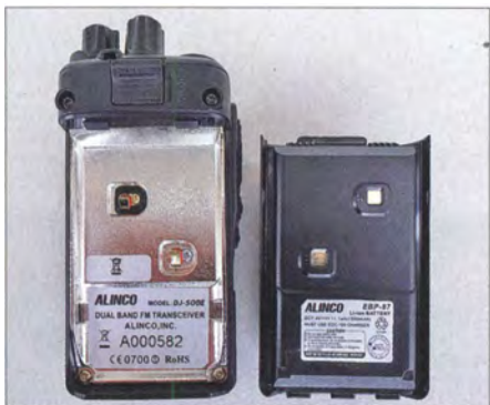
Mit seiner Kapazität von 1,5 Ah ermöglicht der Akkumulator eine lange Betriebsdauer.
