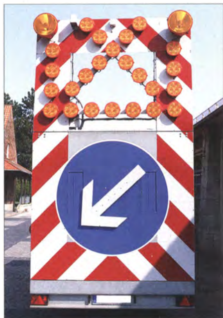
Bild 1: In mehreren Bundesländern sind solche rollenden Warnschilder mit dem CB-Warnfunksystem (CB-GSW) ausgestattet.
