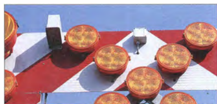
Bild 2: Kaum erkennbar: Am oberen Rand des Warnschildes sind in grauen Gehäusen das Radarsystem (links) und die spezielle CB-Funk-Antenne (rechts) montiert. Fotos: DL1ABJ
