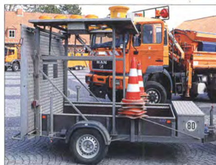
Bild 5: Das CB-GSW schaltet sich automatisch ein, sobald der obere Teil des auf einem Anhänger montierten Warnschildes hochgeklappt ist.
