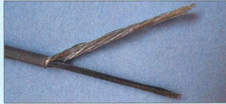
Bild 8: DX-Wire Premium, Kupferdrahtauflage aufgedröselt
