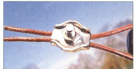
Bild 16: Kastenklammer aus Edelstahl (Drahtdurchmesser bis 3 mm) Fotos: DF2BC
