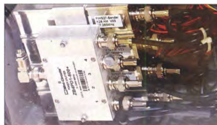
Bild 3: Die Sendeeinheiten liegen geschützt in einem wetterfesten Gehäuse, das auf der Rückseite des Warnschildes oder im Koffer eines Anhängers montiert ist
