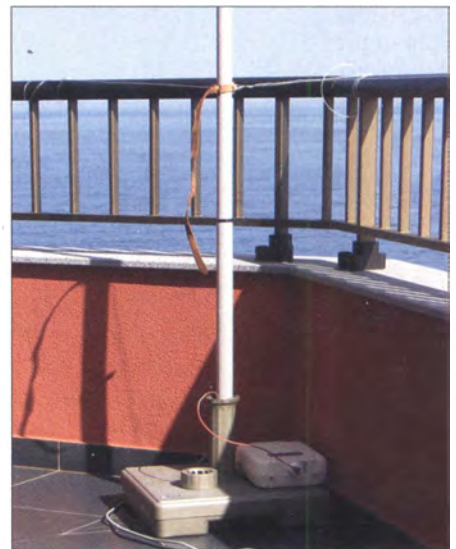
Die 7 m hohe Vertikal (Antennendraht befindet sich im Rohr von DX-Wire)
