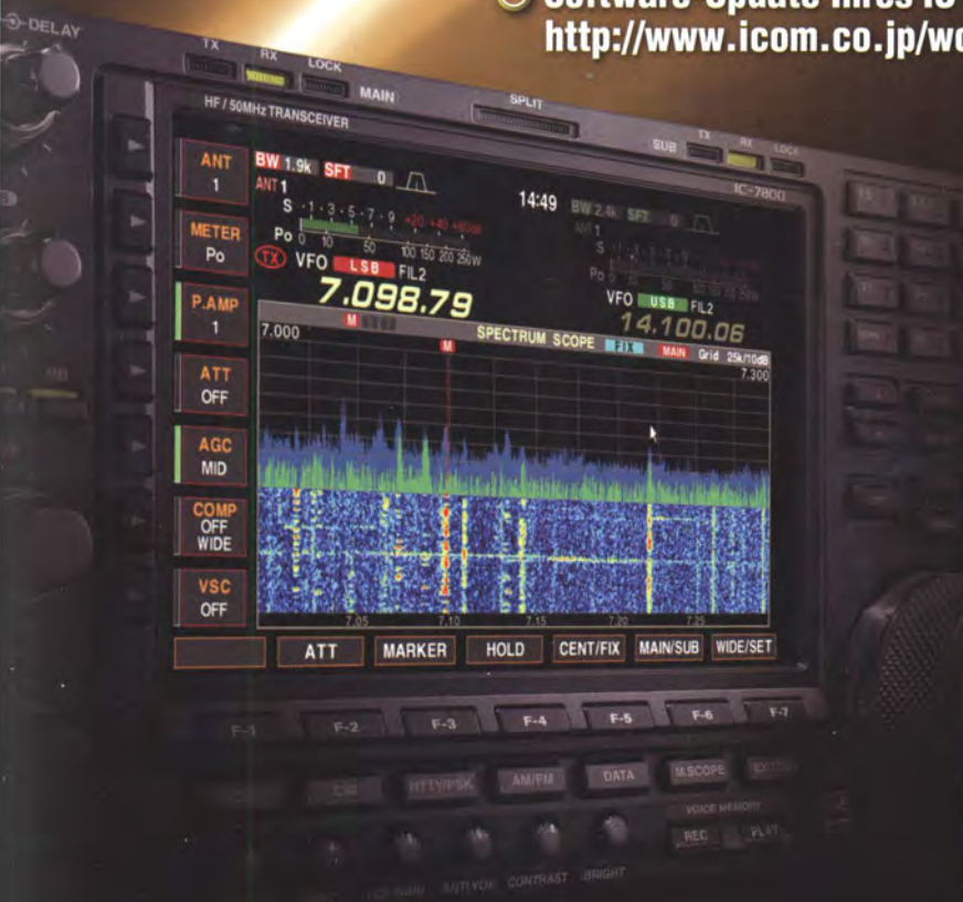
Audioskop-Anzeige mit Wasserfall-Darstellung
