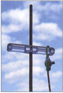
Bild 4: Befestigung des Strahlers am Teleskopmast per Endisolator
