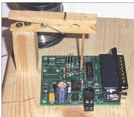
Bild 29: „Dritte Hand“ zum Fixieren eines SMD-Bauteils vor dem Einlöten
