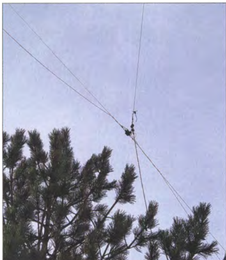
Bild 7: Die FD4-Windom-Antenne ist über einen Klosterinnenhof gespannt.
