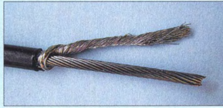
Bild 6: DX-Wire HDL, Kupfergeflecht aufge-dröselt
