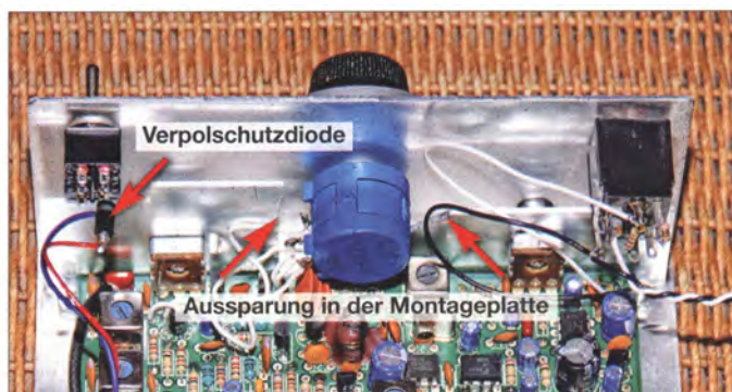
Bild 2: Die Befestigungs- bohrung des alten Potenziometers in der Montageplatte ist so weit zu vergrößern, dass der Körper des 10-Gang- Potenziometers (blau) dort Platz findet.
