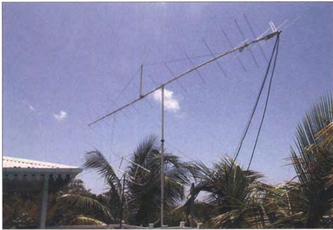
9Y4TBG: Aus Gewichtsgründen wurde auf Rotoren verzichtet: Die Yagi-Antenne haben die OPs mittels Seilkonstruktionen in Azimuth und Elevation ausgerichtet.
