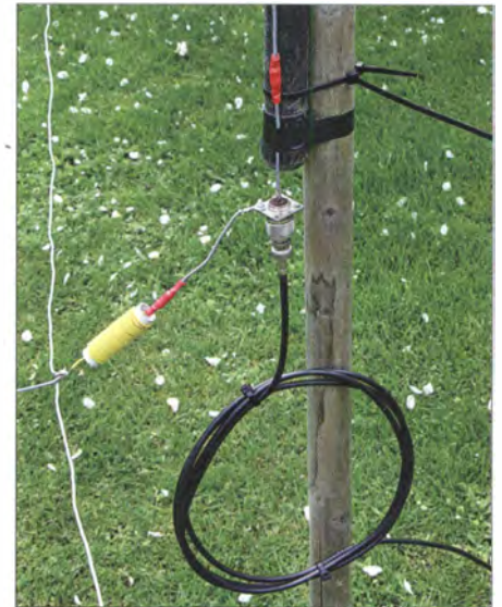
Bild 2: Probeweiser Antennenaufbau im Garten; links sind die drei Radials und die Spule aus gelbem Schaltdraht erkennbar, unten die Mantelwellensperre.
